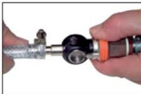
Déverrouillage de la douille de sécurité
